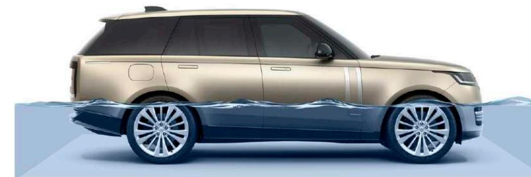
\*Passage à gué de 750 mm (25 degrés à l'entrée et à la sortie), profondeur de gué 900 mm (9 degrés à l'entrée et à la sortie). \*\*L'espace de chargement arrière est réduit lorsque les sièges arrière Executive Class sont sélectionnés. Pour en savoir plus, veuillez contacter votre concessionnaire local.
